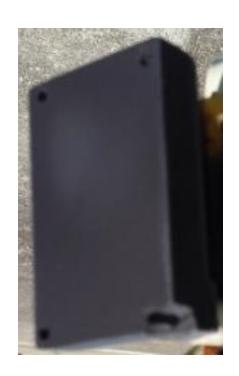
Dimensiones de la placa 0.01X.046X0.03m Se utilizó pintura negra mate resistente a alta temperatura de marca comercial.
